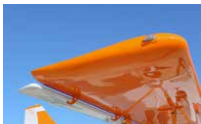
Arriba Las puntas de los planos son de fibra y su forma mejora la estabilidad en vuelo.
