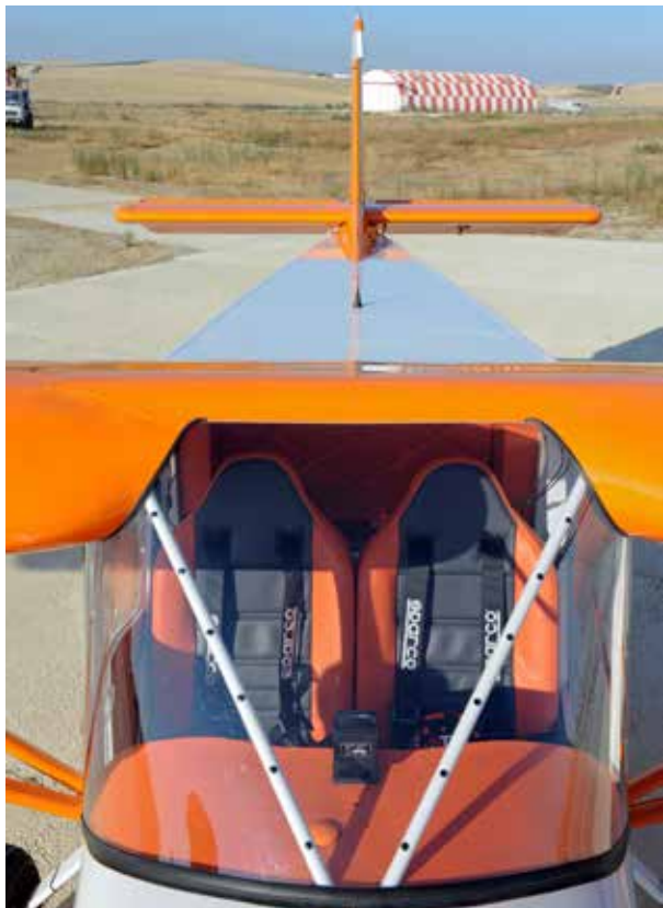
Las puertas se abren hacia arriba y quedan totalmente pegadas a la parte inferior del ala, quedando bloqueadas por un amortiguador de gas.
