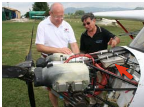
Il motore è montato in posizione decisamente avanzata per non influire sul centraggio, la freccia indica l'airbox
